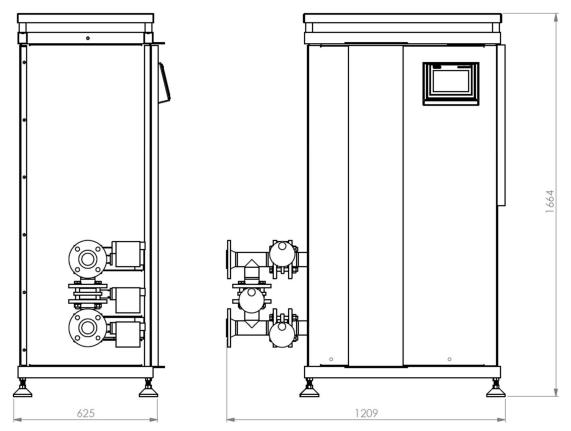
DW300-04i in Konfiguration für die Wasserdesinfektion in einer Waschanlage, Abmaße können bei anderen Anwendungen abweichen.
